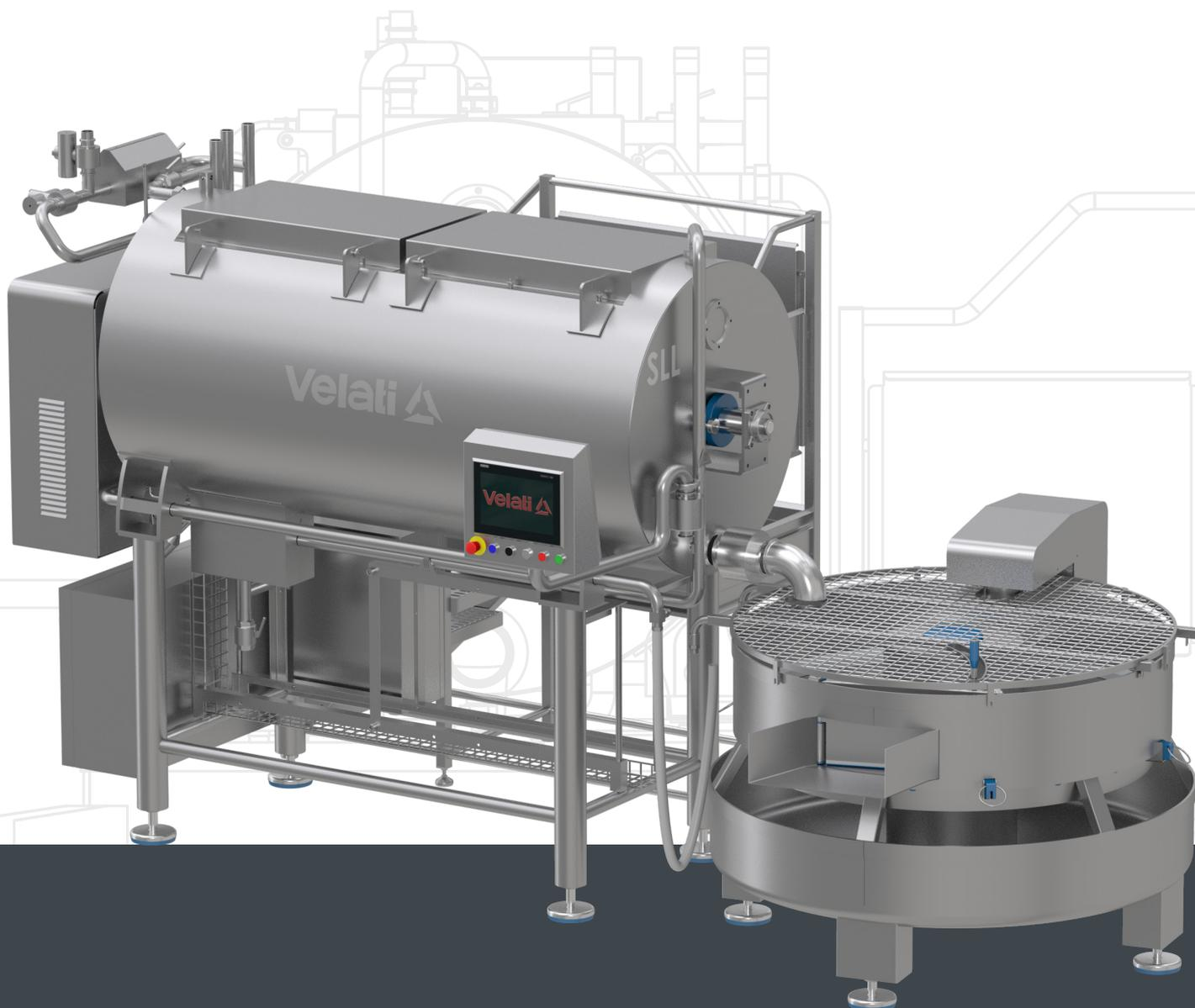
La macchina Scalda Lava Lardello Velati - interamente costruita in acciaio INOX e con materiali idonei al contatto con gli alimenti secondo la normativa MOCA e le linee guida dell'Hygienic Design – è stata sviluppata per il lavaggio del lardello, processo necessario per la produzione della mortadella.
