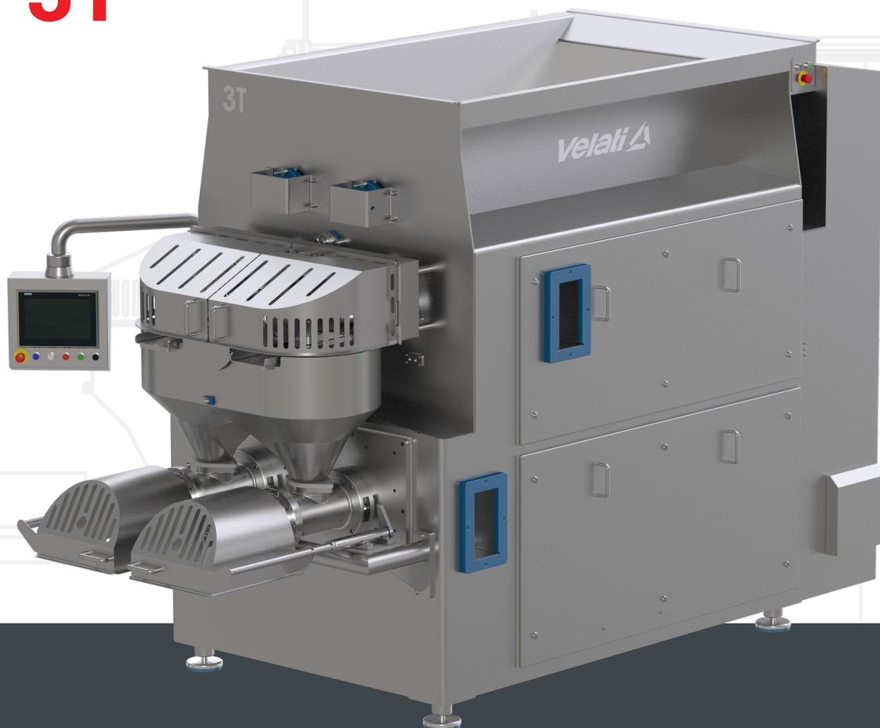
Il tritacarne tripla testa 3T, ideale per la produzione di mortadella, è realizzato in acciaio INOX e con materiali idonei al contatto con gli alimenti secondo la normativa MOCA e le linee guida dell'Hygienic Design.
